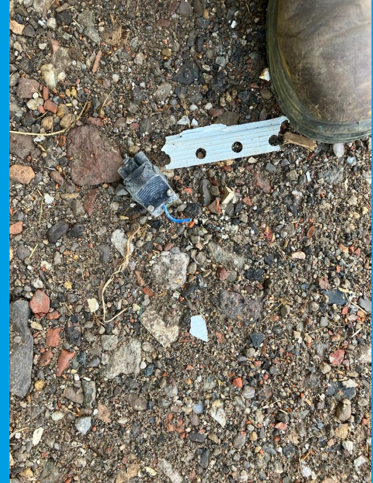
Elektrakabels, stekkers en aluminium profielen in gecertificeerd menggranulaat
