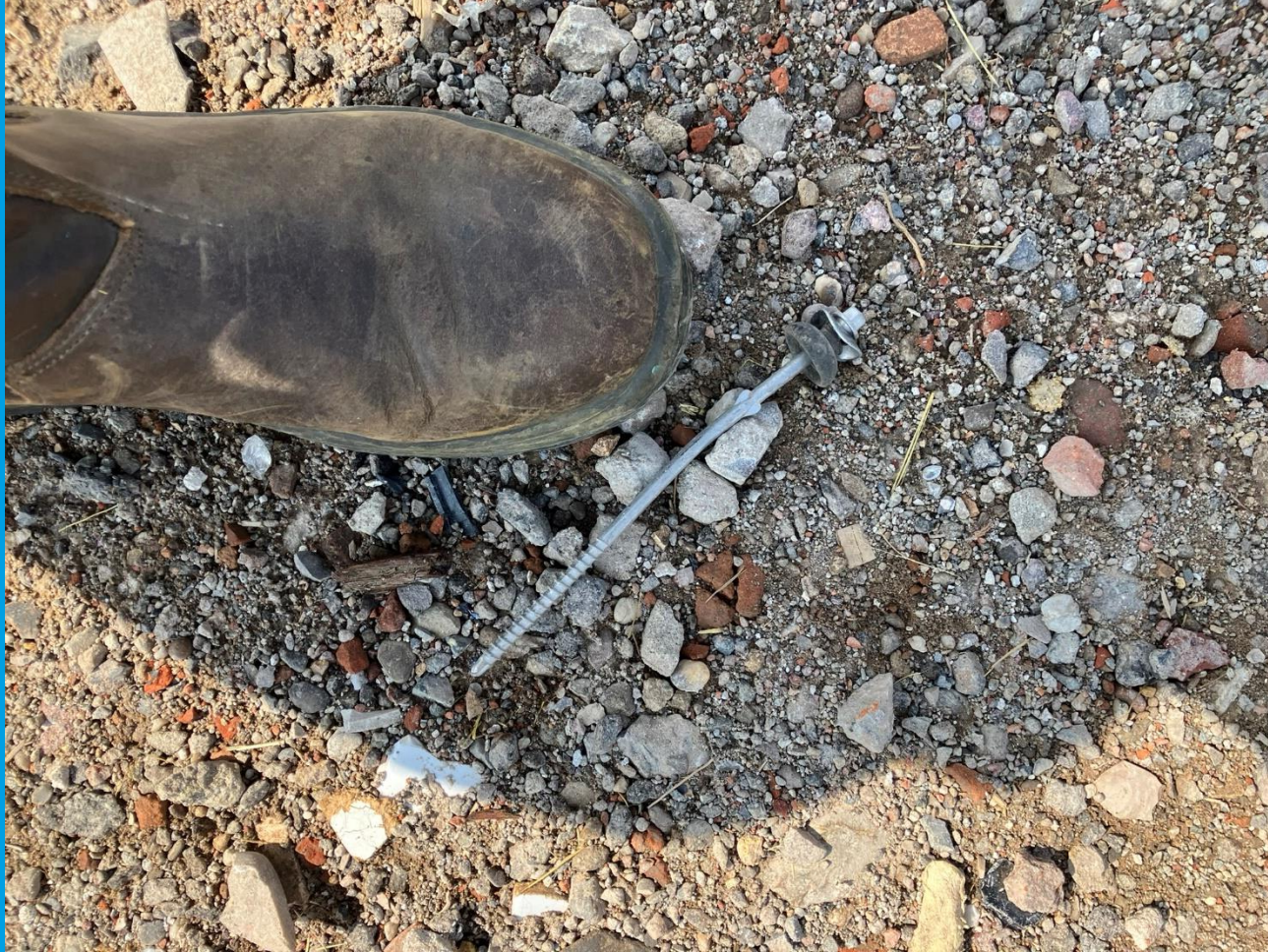
Schroeven, plastic etc. in gecertificeerd menggranulaat
