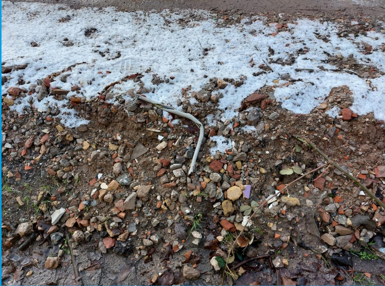
Elektrakabels in gecertificeerd menggranulaat
