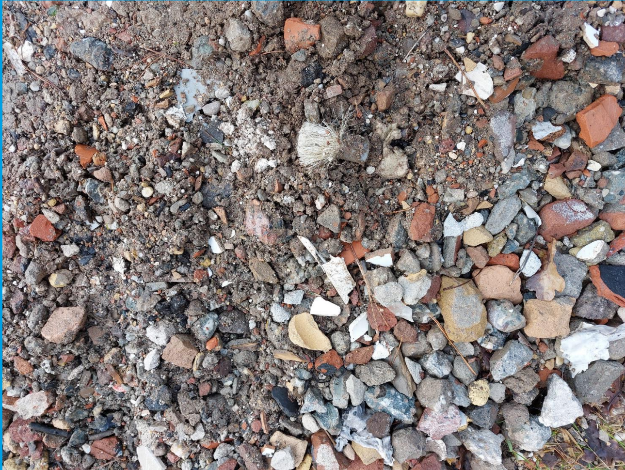
Kwast, plastic etc. in gecertificeerd menggranulaat
